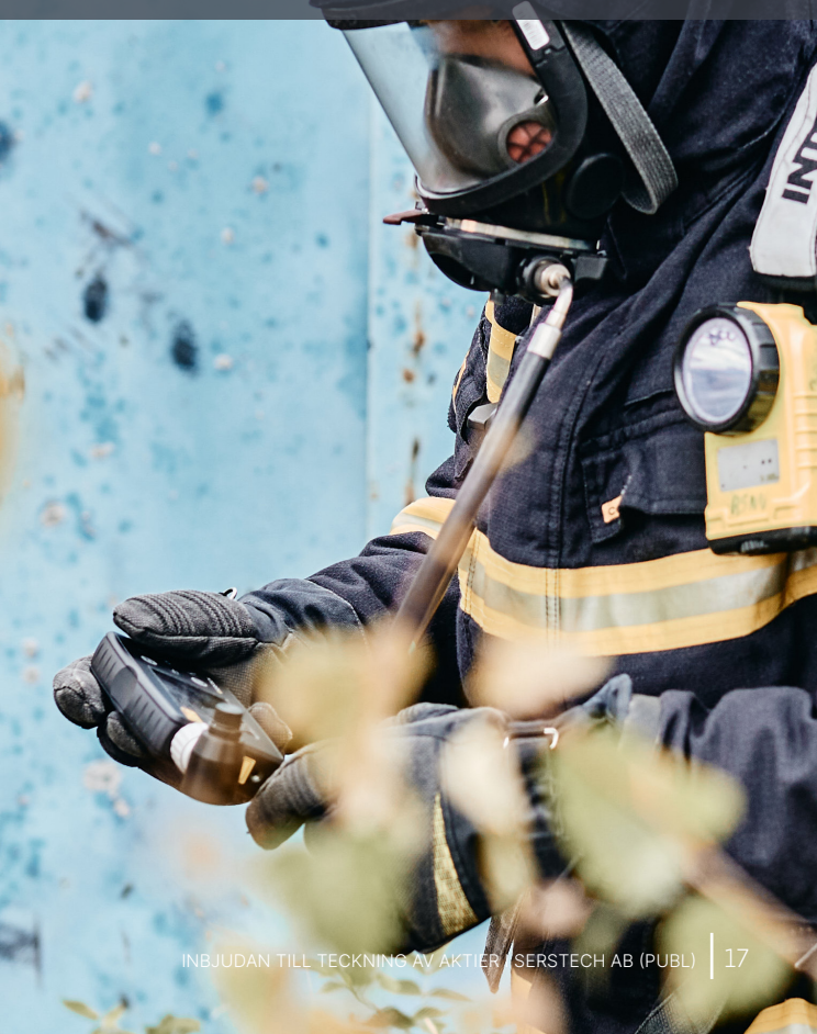
Bolagets handhållna instrument bygger på Ramanspektroskopi
